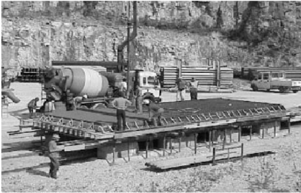
Fig. 3 : Essais de chutes de blocs menés sur dalle PSD à échelle 1/3
