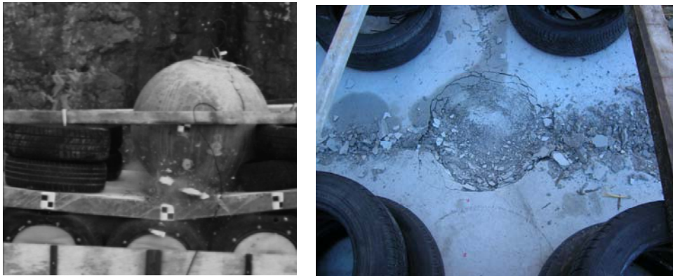
Fig. 10 – A gauche, impact sur la dalle (première phase) + pneus. A droite cratère à la suite d'un impact d'une hauteur de 5m
