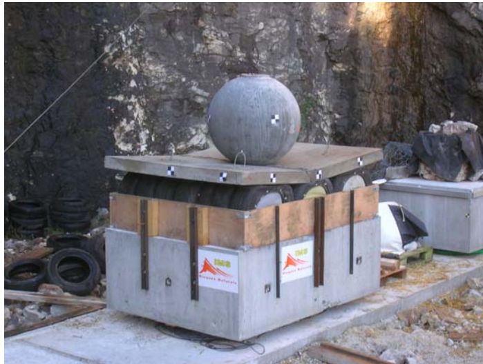
Fig. 9 – structure sandwich et l'impacteur en béton ductal
