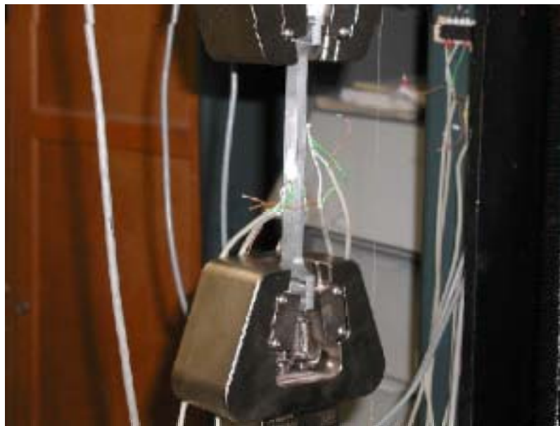
Essai de traction sur une éprouvette en aluminium 6060T5
