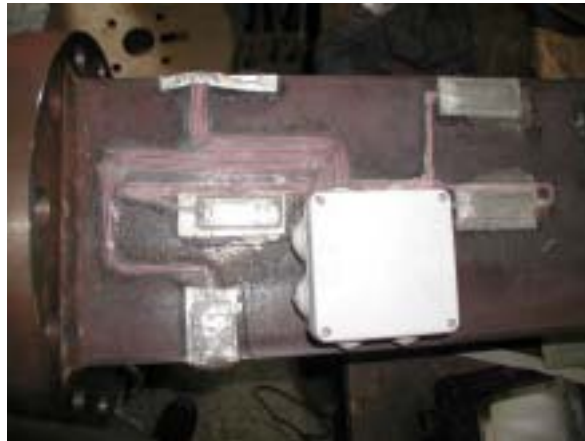
Les différentes jauges sur le pied de la poutre principale
