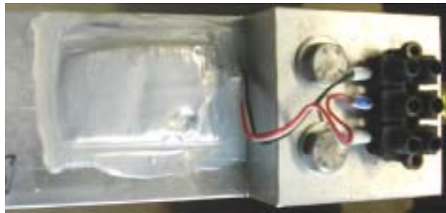
Jauge sous sa protection et connectique
