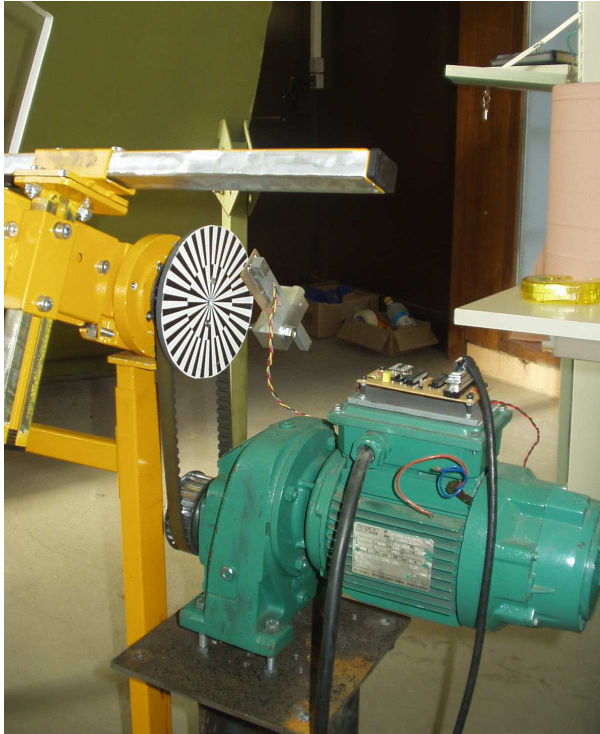
FIG. 5 – (Gauche) Capteur de déplacement angulaire fixé sur le tambour d'entraînement du tapis. Le tambour est couplé au moteur par une courroie crantée. (Droite) Capteur de déplacement angulaire fixé sur une roulette entraînée par le tapis.
