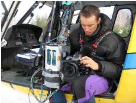
Fig. 2: Dispositif combiné de scannérisation Lidar et de prise de vues
