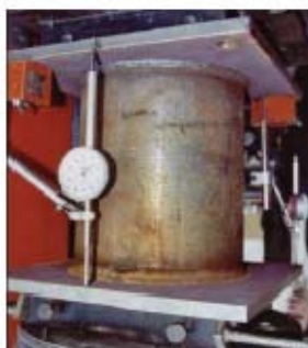
Essais sur appuis fusibles (galerie de Poniente) : avant et après essai d'enfoncement.
