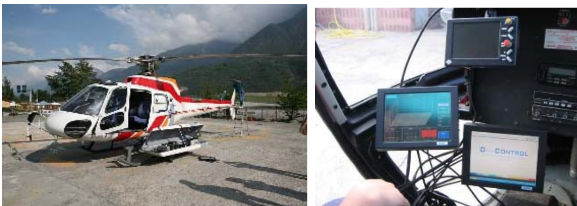
Figure 2.4. 8. Acquisition scanner laser par hélicoptère
