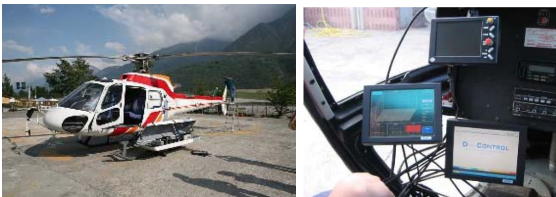
Figure 2.4. 8. Acquisition scanner laser par hélicoptère
