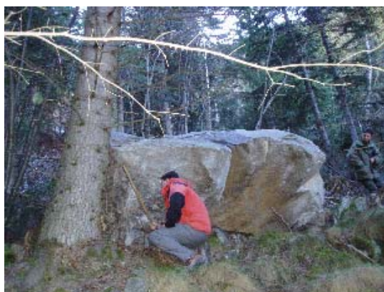
Photo 5.6.3 : Bloc de 5 m 3 arrêté par un épicéa de diamètre 60cm (photos Cemagref, F. Berger, 2005)
